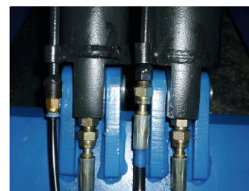
Figure 19 position de fixation de l'interrupteur fin de course
